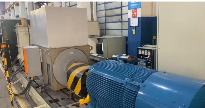
MOTOR DE ALTA TENSÃO ACOPLADO AO DINAMÔMETRO
